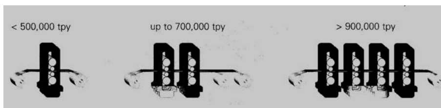
Рисунок 4.8 – Основні типи станів холодної прокатки: одноклітьовий реверсивний (а), двохклітьовий реверсивний (б), безперервний багатоклітьовий (в)
